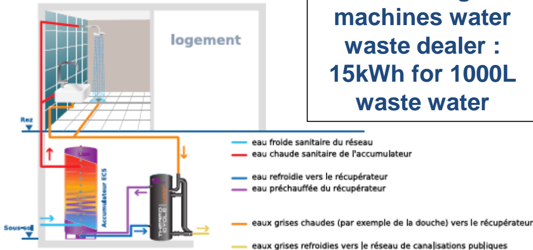
ThermoCycle® WRG - Le système de préchauffage idéal
